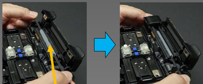
Máx. 6.0mm diâmetro antes da retracção
