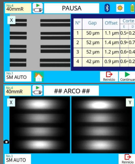
Controlo automático da fusão por contagem de fibra
