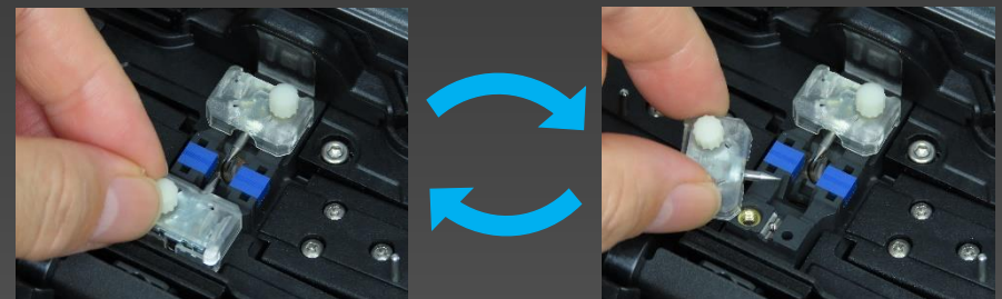
Remplacement des électrodes sans outil
