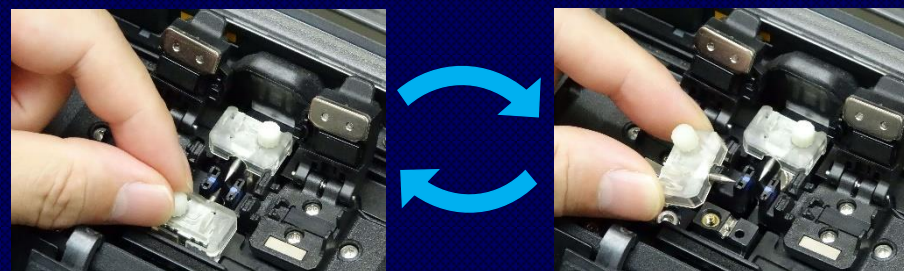
工具無しで電極棒交換可能
