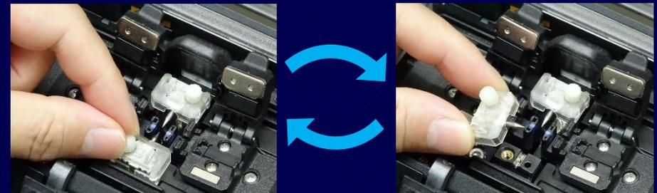
Remplacement des électrodes sans outil
