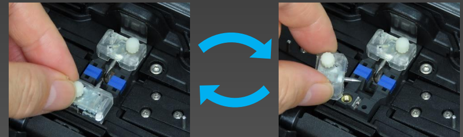
工具無しで電極棒交換可能
