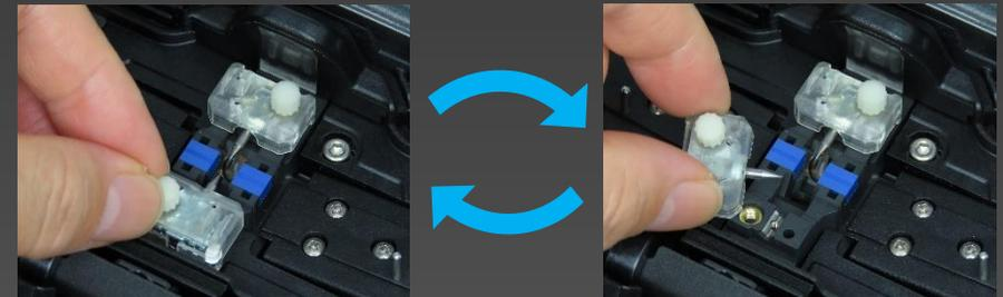
Reemplazo de electrodos sin herramientas
