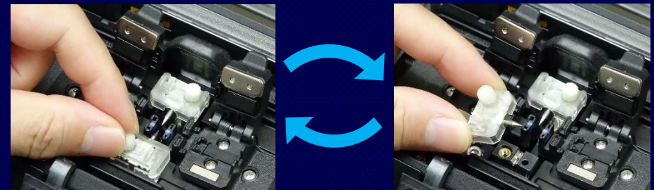
Sustitución de electrodos sin herramientas
