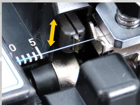
簡単なボタン操作で切断刃ポジションを自動変更。刃が摩耗した時のメンテナンスが容易になりました。
