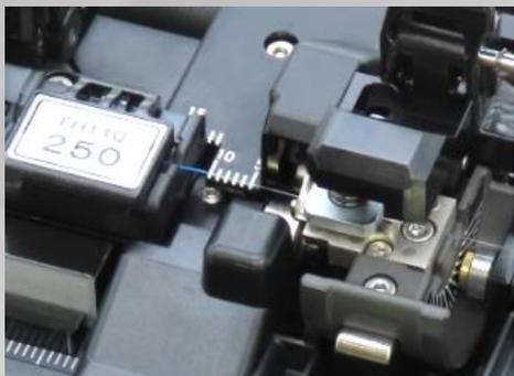
光ファイバにかかる張力をモータで制御。張力変更に工具を必要とせず、且つ安定した張力で切断が可能です。
