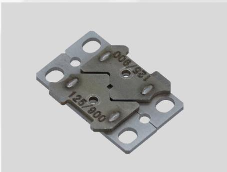
クラッド径 125 $\mu$ m/被覆径 900 $\mu$ m、クラッド径 80 $\mu$ m/被覆径 160 $\mu$ m 等の光ファイバに対応した被覆除去刃をご用意しました。
