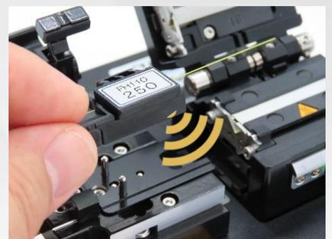
RFID を内蔵したファイバホルダ FH110 シリーズと組合せてご使用いただくことで、適切な被覆除去条件が自動で選択されます(\*1)。
