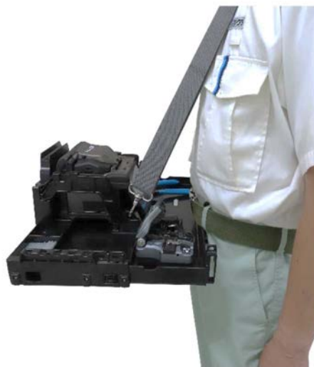
スペース拡張、ストラップとベルトフックにより架空作業でも安定
